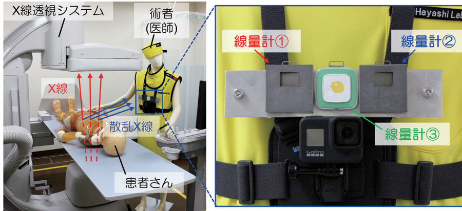
図2：被ばく線量測定に関する研究。 3台の検出器の信号を Mathematica で解析することで、X線の入射角度を算出する
