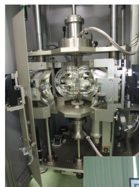
◀ 図3：単結晶を育成するための赤外線集中加熱炉
