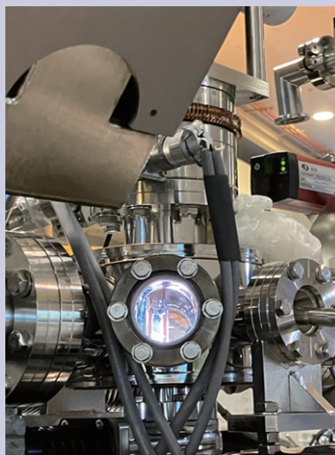
図 2：PF BL-16A の実験風景 ホルダーに評価試料をセットした状態。測定は超高真空チャンバー内で実施する。
