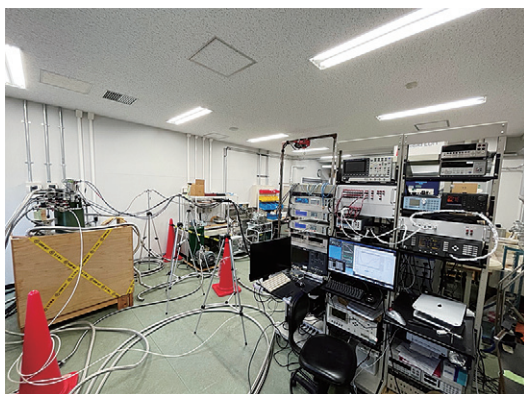
図 1: 実験室の様子。圧力 3 万気圧，温度 0.3 ケルビン，磁場 16 テスラの条件下で電気抵抗やインピーダンス，交流帯磁率を測定している。
